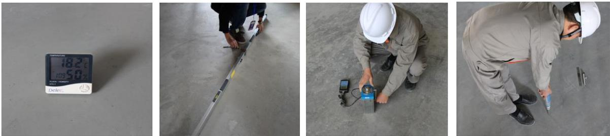
现场环境检测、基础地面检查、破损及开裂处标注
