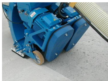
抛丸机地面处理
